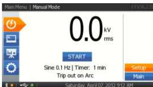
Начните измерение, когда все отображаемые на экране параметры измерения корректны. Вращайте Шайбу (5) пока поле "START" меню не подсветится. Для запуска теста нажмите на Шайбу (5)
