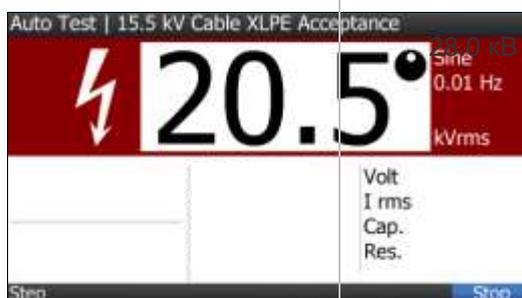
Вращайте навигационное колесо (5) для изменения подаваемого испытательного напряжения.
