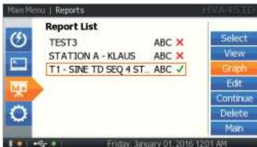
Выберите иконку “Graph” для просмотра графика зависимости Тангенса от приложенного напряжения на экране прибора HVA. Данный отчет возможен если Вы используете **установки** с модулем TD.
