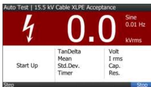
Данный экран сообщает пользователю, что установка HVA готова и сейчас начнет подачу высокого напряжения и измерение
