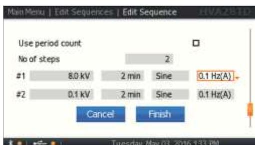
Установите частоту испытания
