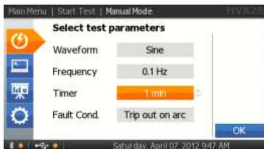
Для изменения продолжительности испытания, поверните навигационную шайбу (5).
