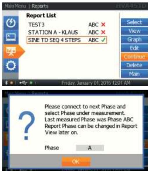
Выберите “Continue” для продолжения измерения. Выберите тестируемую фазу. На экране отображается последняя рабочая фаза. Для ввода, выберите “OK” при помощи навигационной шайбы и нажмите на нее. Эта функция позволяет Вам начать измерение на 3-х фазной системе сейчас, а закончить в любой момент позже.
