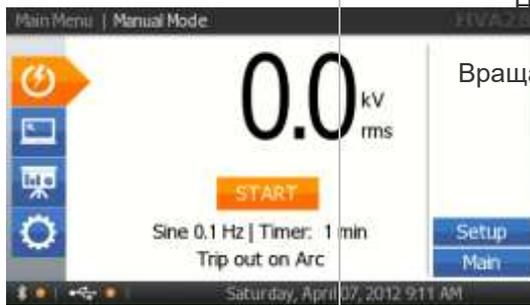
Начать испытание, когда параметры испытания, отображаемые на экране правильные.
