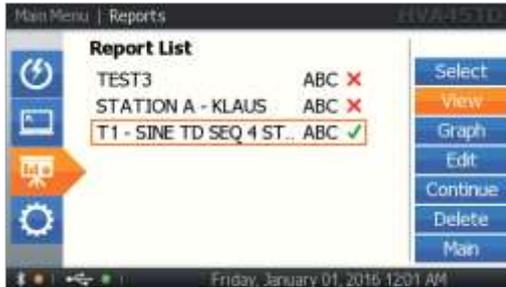
Выберите “View” для просмотра протокола на экране прибора.
